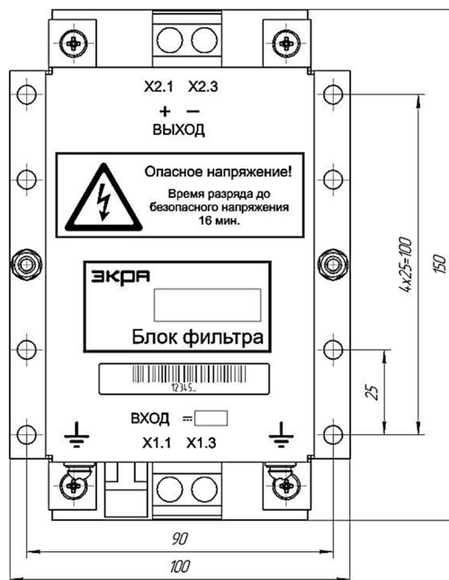
Рисунок 2 - Габаритные и установочные размеры блока фильтра
